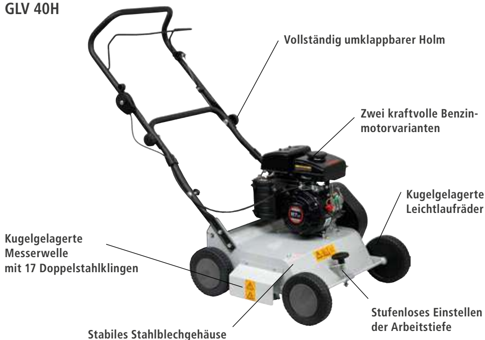
Kugelgelagerte Vertikutierwelle mit gehärteten Doppelstahlklingen
