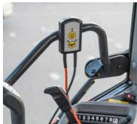
Steuerpult mit Magnetanbringung zur Umschaltung und Bedienung beider Schare (Anschluss über Zigarettenanzünder)
