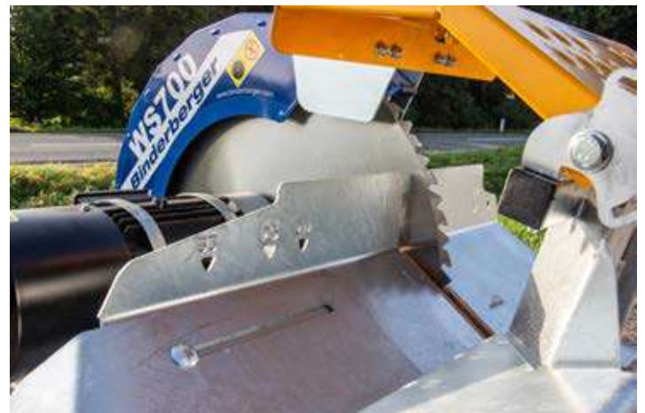
Wippe mit Schutzkäfig und eingelassenen Längensmarkierungen
