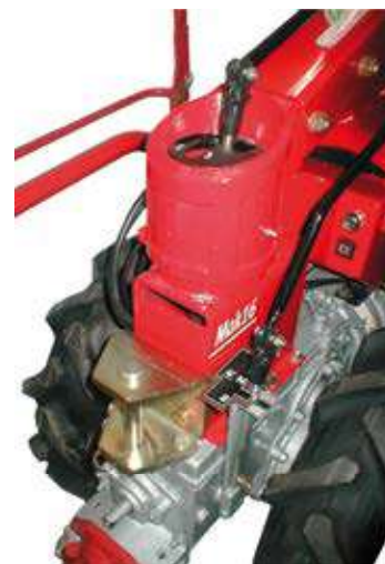
Schaltkulis, Anhängerkupplung + Zapfwelleneinstellung MAK 17
