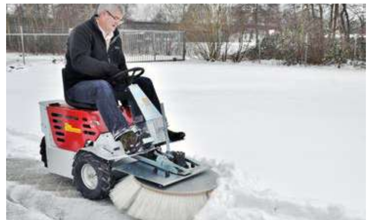
Die Arbeitsbreite des R 1000 beträgt 100 cm, die Bürste lässt sich sowohl links- als auch rechtsrum drehen. Ideal geeignet zum Schmutz- u. Schneekehren.
