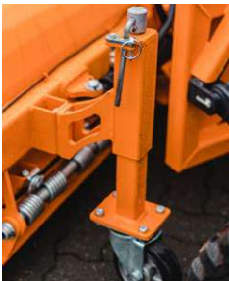
stufenlos höhenverstellbare Stützräder
