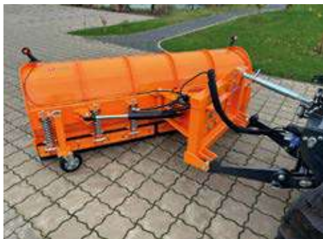
Federklappen als Überfahrtschutz, höhenverstellbare Stützräder
