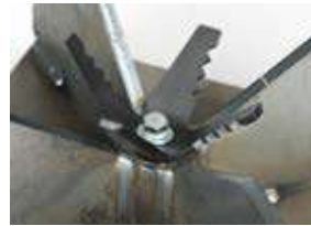
Piranha-Messer zur Volumenreduzierung
