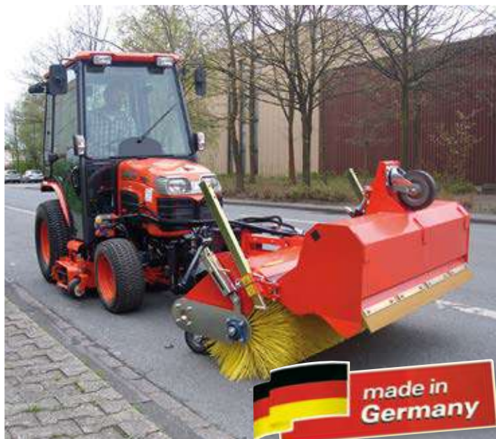
Abstellstütze und stufenlos höhenverstellbare Kehrwalze
