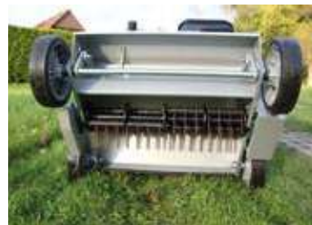
Am Fliehkraftsystem aufgehängte, gehärtete 3mm Vertikutiermesser
