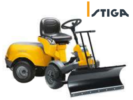
Schneeschild Park 500 / 700 / 900 Serie mit 120 cm Räumbreite, Stahlleiste, links und rechts schwenkbar
