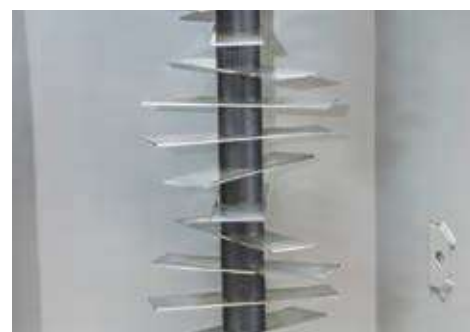
Kugelgelagerte Vertikutierwelle mit gehärteten Doppelstahlklingen
