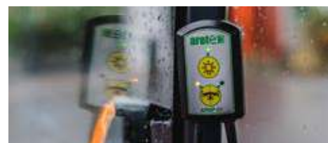
Steuerpult mit Magnetanbringung zur Umschaltung und Bedienung beider Schare (Anschluss über Zigarettanzünder)
