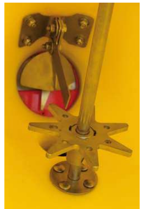
zusätzliches Rührwerk gegen Brückenbildung
