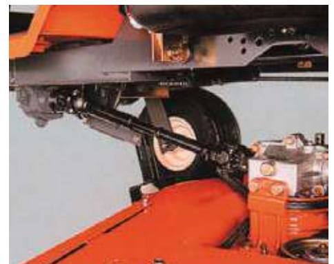
Messerantrieb über Kardanwelle bei allen Modellen.
