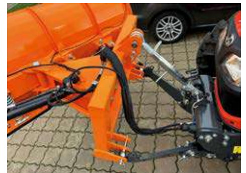
hydr. Seitenverstellung mit 2 Zylindern, 3-Punkt-Aufnahme Kat. I / II
