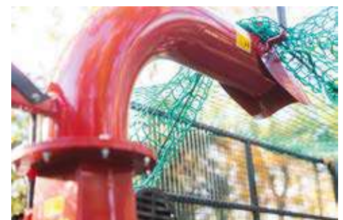
Schwenkbarer Auswurfkanal und verstellbare Auswurfklappe
