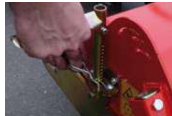
Höhenverstellung der Bürste
