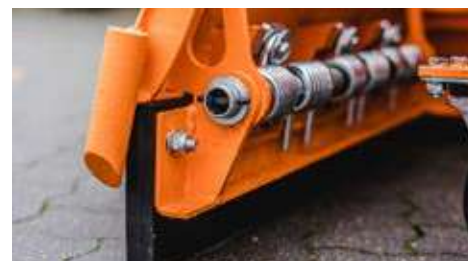
Federklappenelemente mit Gummileiste
