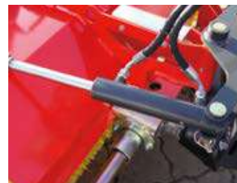
hydraulische Seitenverstellung (optional)
