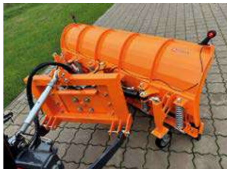
Niveaueingleich, seitlicher Anfahrtschutz
