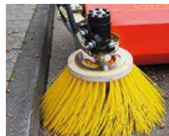
hydraulisch angetriebener Seitenbesen (optional)
