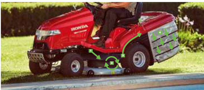
▲ Mähdeck mit synchron laufenden Messern
