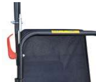
klappbarer Lenkhalm mit Schnellverschluss (werkzeuglos)
