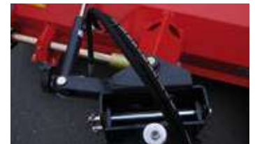
hydraulische Seitenverstellung (optional)
