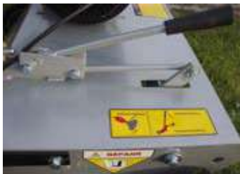
Stabiler Absenkmechanismus mit Feinjustierung
