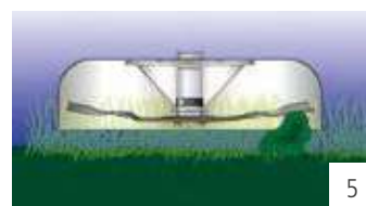
Austausch der komplett montierten Absorber-Einheit
