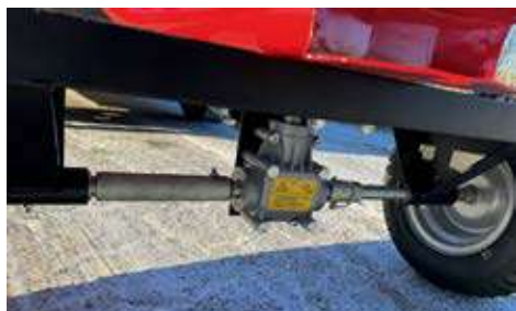
Verstärktes Metallgetriebe mit zuschaltbarem Freilauf für Überführungsfahrten
