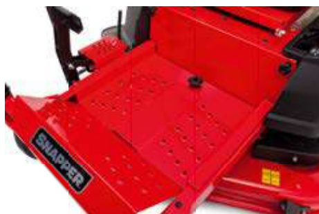
Abnehmbare Bodenplatte für einfachen Wartungszugang
