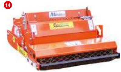
14 Umkehrfräse 64 cm mit Motorfrontgewichten, Gitterwalze
