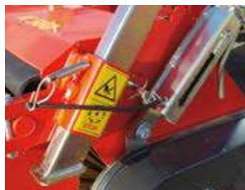
Abstellstütze und stufenlos höhenverstellbare Kehrwalze
